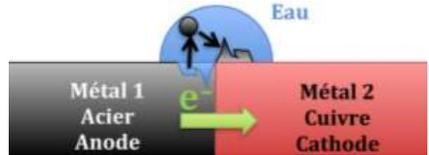
Dans le cas de l'acier, la **corrosion galvanique** se produit quand trois conditions sont réunies : deux métaux de natures différentes sont mis en contact et immergé dans un milieu aqueux agissant comme un électrolyte.
