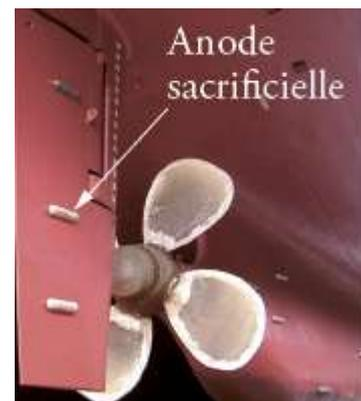
L'objectif de l'exercice est d'évaluer, à l'aide des documents ci-après, la masse de l'anode sacrificielle nécessaire à la protection d'un bateau.
