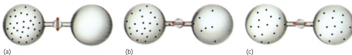
Figure 5 L'expérience de Joule. (a) Tout le gaz est contenu dans le flacon de gauche, celui de droite étant vide. (b) On ouvre le robinet reliant les deux flacons : une partie du gaz se déplace dans le flacon de droite. (c) À l'équilibre, la pression du gaz est identique dans chacun des flacons et le désordre a augmenté.
