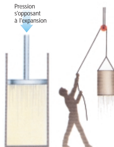
Figure 3 Analogie entre travail d'expansion d'un gaz et travail contre la gravité terrestre. La situation d'un gaz, où celui-ci repousse un piston subissant une pression extérieure qui s'oppose à son déplacement, est analogue à celle d'une personne soulevant une masse donnée, que la gravité terrestre a tendance à maintenir au sol. Dans les deux cas, l'énergie mise en jeu est transmise au milieu extérieur.
